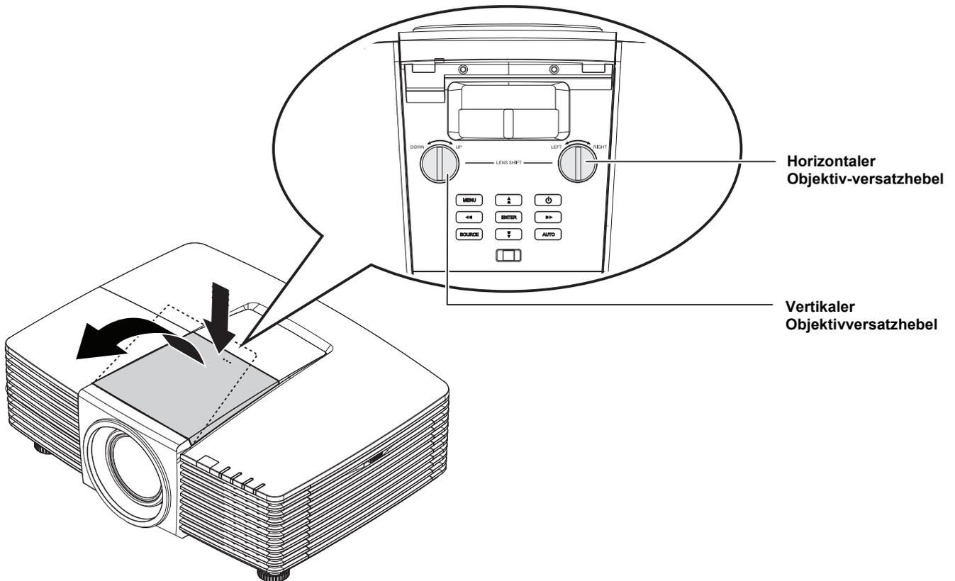
Die Objektivversatzfunktion ermöglicht einen Objektivversatz, der der Anpassung der vertikalen oder horizontalen Position des projizierten Bildes innerhalb des nachstehend angegebenen Bereichs dient.
