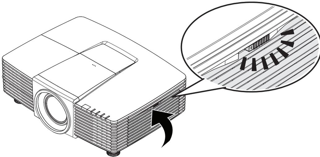
6. Schalten Sie den Projektor ein und setzen Sie den Luftfiltertimer nach Auswechslung des Luftfiltermoduls zurück.
